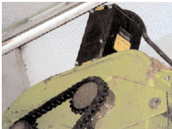
Mesure instantanée par capteur du débit de grains récoltés.
